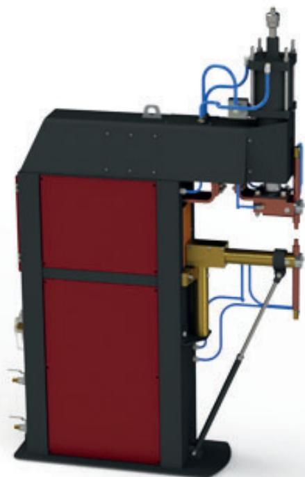
**Машина МТ-1950** предназначена для контактной точечной сварки переменным током деталей из низкоуглеродистых сталей, легированной стали 12Х18Н9Т, титановых сплавов марки ОТ4, алюминиевых сплавов и крестообразных соединений стержней арматуры классов AI, AII, AIII.
